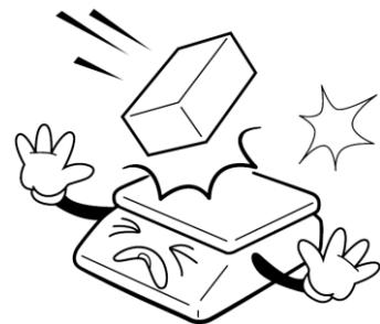
Nepřetěžujte vaši váhu výrazně nad její deklarovanou maximální váživost. Při přetížení více než 120% max. váživosti by mohlo dojít ke zničení snímače zatížení ve váze.
