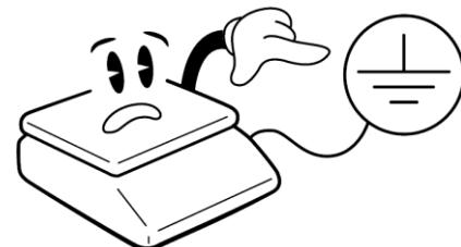
Váha se nesmí provozovat v elektromagneticky nebo elektrostaticky exponovaných prostředí, např. poblíž vysokonapěťových kabelů, elektromotorů, TV přijímačů, a dalších zařízení. Váhu neobsluhujte v oděvech, které mohou vytvářet elektrostatický náboj.
